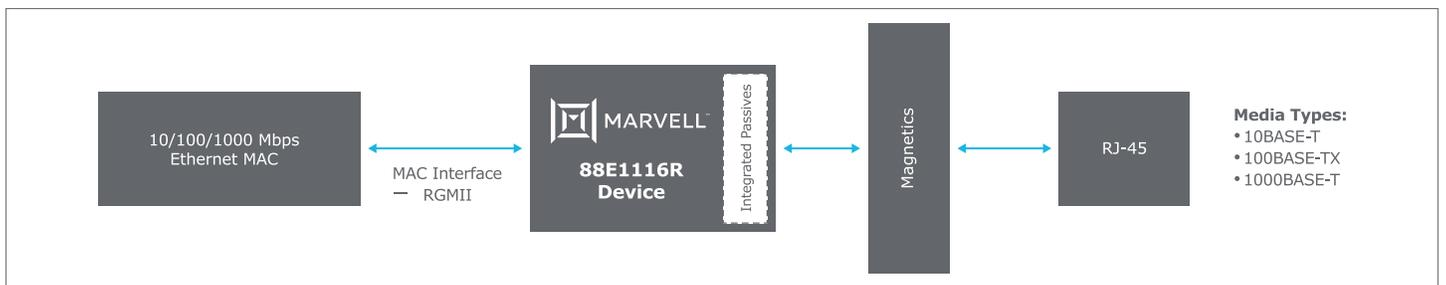
Fig 2. 88E1116R System Diagram
